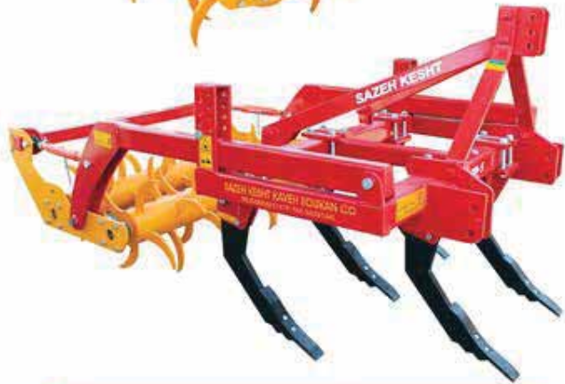
جیزل پکر ۵ شاخه سوپر با غلطک چنگالی دوبل (عرض کار ۱/۵ متر)
