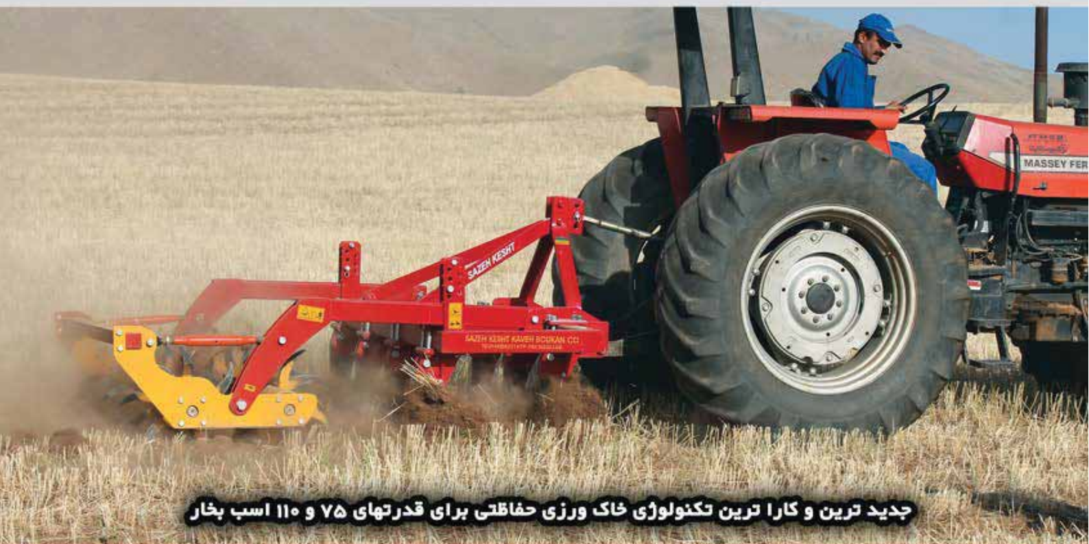
جیزل پکر ۵ شاخه سوپر با غلطک چنگالی دوبل (عرض کار ۱/۵ متر)
