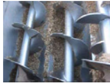
شکل ۴- TMR های باقیمانده پس از اتمام عرضه خوراک در زیر اوگر ها نشان می‌دهد که آنها فرسوده و توانایشان برای مخلوط کردن را از دست داده‌اند.
